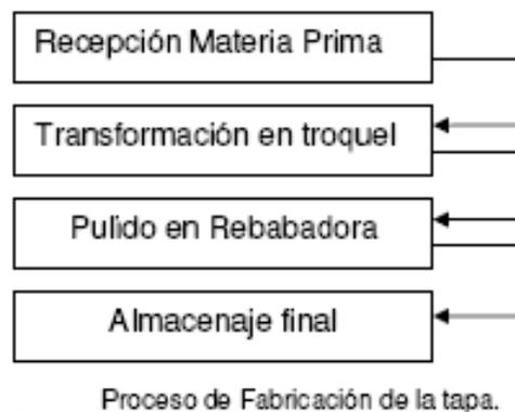
Definido el Proceso de Fabricación se recopila todo el material técnico (Normas, Especificaciones, etc...) necesario para la realización del Proyecto completo a fin de no retrasar ninguna fase posterior.
