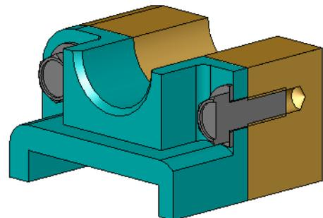
Una vista de sección le permite observar el ensamblaje como si tomara un serrucho y lo cortara hasta abrirlo.
