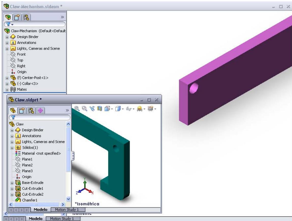
9 Agregue el componente Claw al ensamblaje utilizando SmartMates.
