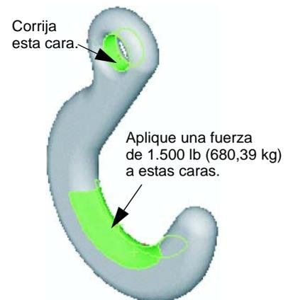
Siga las instrucciones detalladas en *Análisis de diseño: SolidWorks SimulationXpress: Uso del análisis para guardar material* en los Tutoriales de SolidWorks. En esta lección, utilice los resultados de SolidWorks SimulationXpress para reducir el volumen de una pieza.
