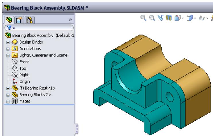
del cojinete mediante pernos. Los taladros del soporte del cojinete están diseñados para permitir que los pernos los atraviesen pero que no queden sueltos. Los taladros en el bloque del cojinete son taladros roscados. Los taladros roscados están específicamente diseñados para actuar como las tuercas. En otras palabras, el perno se atornilla directamente en el bloque del cojinete.
