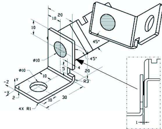
**Brackets** (Soportes): 2 mm de grosor e igual tamaño (taladros por todo). Material: Aleación 6061, Densidad = 0,0027 g/mm<sup>3</sup>. El borde superior de la muesca se encuentra a 20 mm del borde superior del soporte mecanizado.
